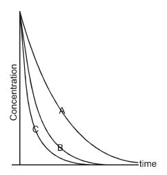
These profiles imply that the decay constants  $k_{_A}$ ,  $k_{_B}$  and  $k_{_C}$  follow the order (A)  $k_{_A} > k_{_B} > k_{_C}$  (B)  $k_{_A} > k_{_C} > k_{_B}$  (C)  $k_{_B} > k_{_A} > k_{_C}$  (D)  $k_{_C} > k_{_B} > k_{_A}$
